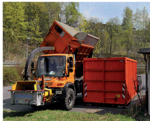
Multitalent: Der Unimog befüllt einen Großcontainer mit seinem heb- und kippbaren Huber-Spezialaufbau, das bringt den Vorteil, dass Beladungsprozesse mit Radladern entfallen können
