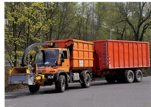
Tandem-Fahrgestell: Der Wechselcontainer des Kröger „agroliner“ kann an jedem Einsatzort abgestellt und wieder aufgenommen werden (links). 17 t geballte Nutzlast: Unimog U 500 mit Kröger „agroliner“ für den Transport von Hackselgut.
