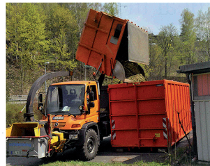
Multitalent: Der Unimog befüllt einen Großcontainer mit seinem heb- und kippbaren Huber-Spezialaufbau, das bringt den Vorteil, dass Beladungsprozesse mit Radladern entfallen können
