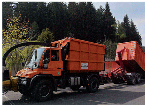
Tandem-Fahrgestell: Der Wechselcontainer des Kröger „agroliner“ kann an jedem Einsatzort abgestellt und wieder aufgenommen werden (links). 17 t geballte Nutzlast: Unimog U 500 mit Kröger „agroliner“ für den Transport von Hackselgut.
